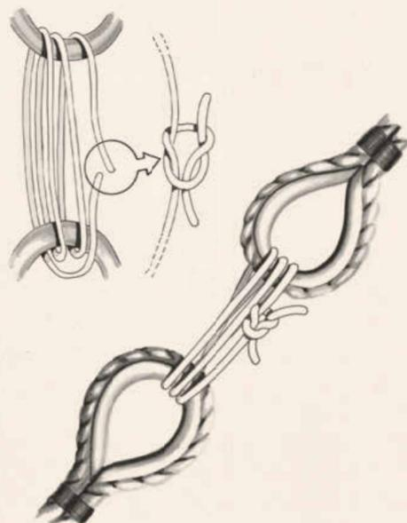
Lorsqu'on désire joindre deux cosses, voici un petit amarrage efficace et rapide à mettre en place. C'est un nœud plat qui vient terminer l'ouvrage.
