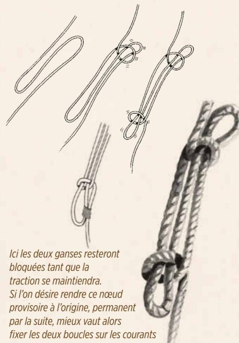
Ici les deux ganses resteront bloquées tant que la traction se maintiendra. Si l'on désire rendre ce nœud provisoire à l'origine, permanent par la suite, mieux vaut alors fixer les deux boucles sur les courants au moyen d'une ligature (génopie).
