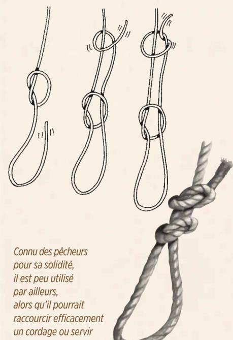
Connu des pêcheurs pour sa solidité, il est peu utilisé par ailleurs, alors qu'il pourrait raccourcir efficacement un cordage ou servir d'amarrage provisoire.
